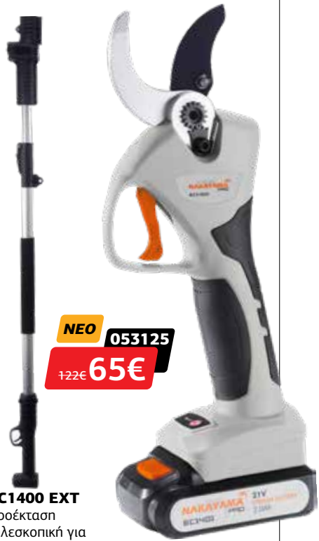
EC1400 Ψαλιδο κλάδου μπαταρίας, 21V με μπαταρία 2Ah li-ion, φορτιστής σε βαλίτσα • Προσδευτική διπλή κοπή Ø0-30/0-40mm • Χρόνος λειτουργίας 2-3h • Βάρος εργαλείου 970g • Προσδευτική κοπή • Οθόνη LED
